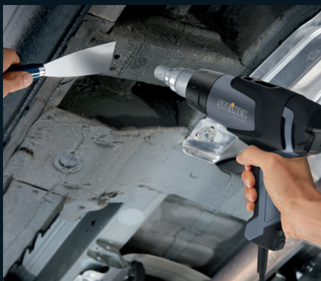
Odstranění ochranného nátěru spodku vozidla
