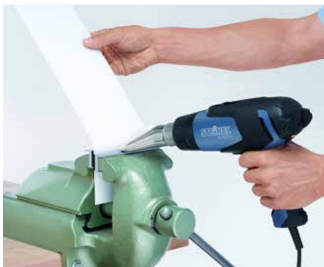
Tvarování. Plast se do požadovaného tvaru cíleně vytvaruje působením tepla.
