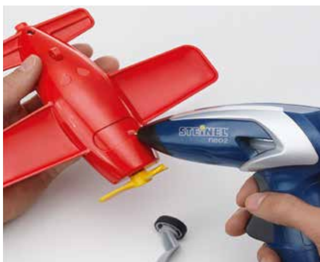
Spojování. Rychlá oprava plastové hračky pomocí tavného lepidla.
